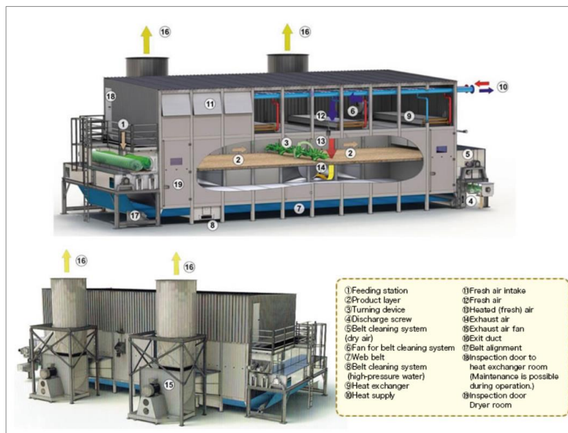
3.17. attēls. Mēsļu žāvēšanas iekārtas
