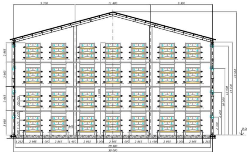
3.10. attēls. Dējējvistu turēšanas novietnes šķērsriezuma profils
