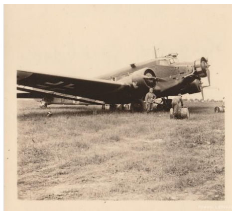
Attēls Nr. 2. Trešā reiza kara lidmašīna Junkers Ju 52, sauktu par "Tanti Ju" Jēkabpils kara aerodromā degvielas uzpildes laikā. Avots: www.zudusilatvija.lv
